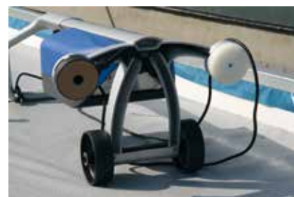
De zwarte rechterkop is de laskop terwijl de linkse witte de temperatuur- en werkomstandigheden opmeet zodat de machine zich automatisch kan aanpassen
